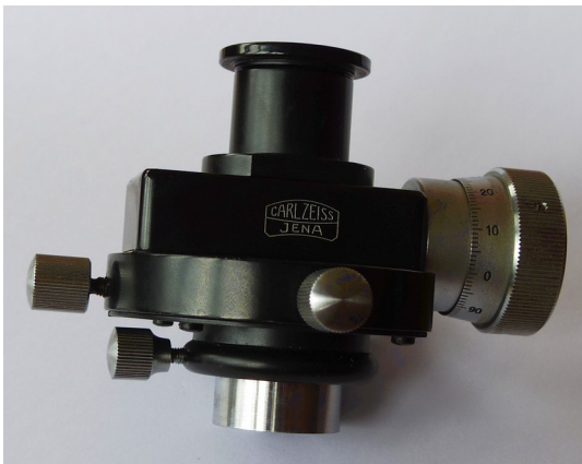
Bild 1: Messschrauben-Okular, Carl Zeiss Jena, ab 30er Jahre
