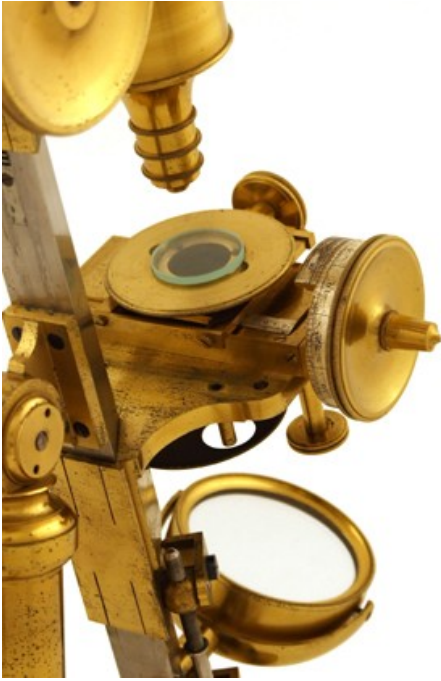
Bild 3: Mikroskop von Firma Schiek, 1840. Der Objektivführer hat eine Auflösung von 0,27\ \mu\text{m} . Dieses Gerät stellte damit zu seiner Zeit den Gipfel der technischen Entwicklung dar. (Foto: Dr. Timo Mappes, www.musoptin.com , sehr sehenswerte Website)
