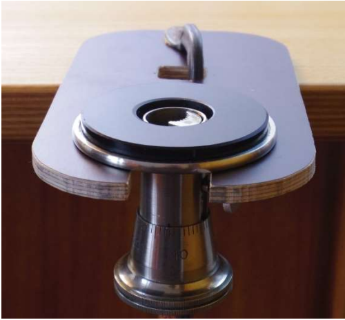
Foto 5: Zylindermikrotom mit Halter
